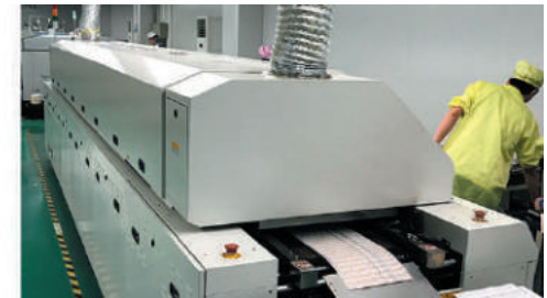
Horno de secado sellando soldaduras
