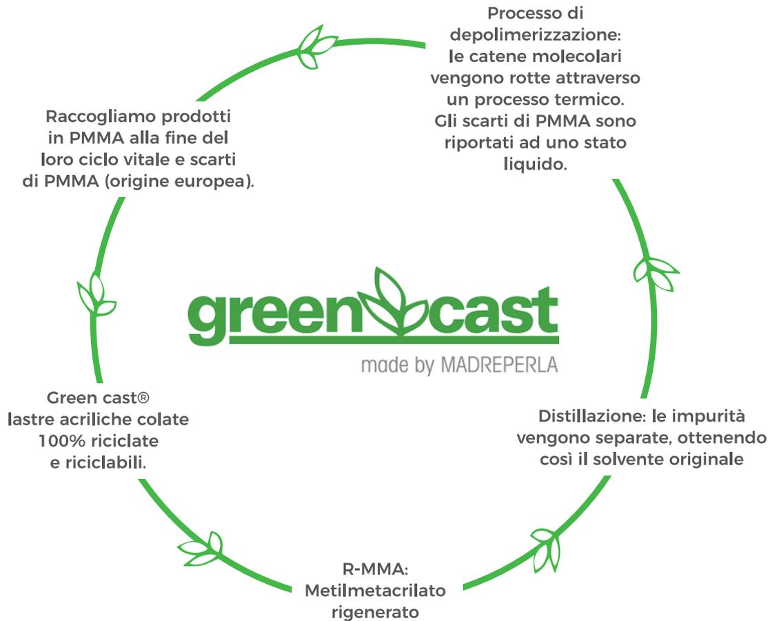
Il processo di rigenerazione di scarti di PMMA permette di ottenere nuovamente la materia prima di alta qualità, il Monomero rigenerato (R-MMA).
